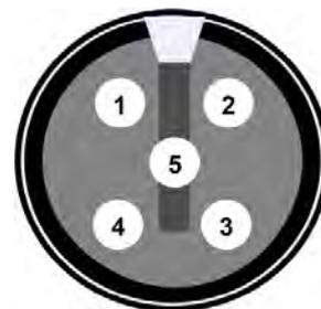
\* El color de los cables corresponde a los cables de VPIstruments Conector hembra M12 de 5 pines
