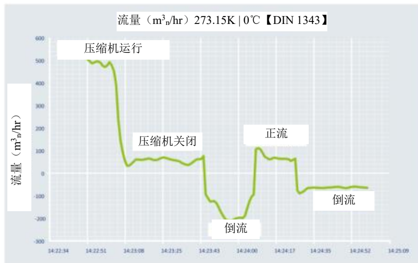
图为: 待机状态压缩机储气罐的“吐纳”情况
