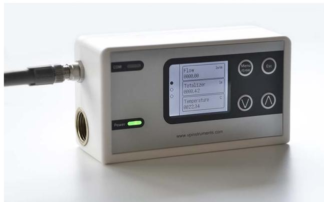
Mit den bahnbrechenden kleineren Durchmessern ist das VPFlowScope In-Line 3/8 Zoll die perfekte Lösung, um geringe Druckluft- und Sauerstoffströme am Einsatzort zu messen. Das VPFlowScope In-Line 3/8 Zoll kann Durchfluss, Gesamtdurchfluss und Temperatur gleichzeitig messen. Über den Modbus und die analogen Ausgänge können Sie eine Schnittstelle zu VPVision oder anderen Energieüberwachungssystemen herstellen.
