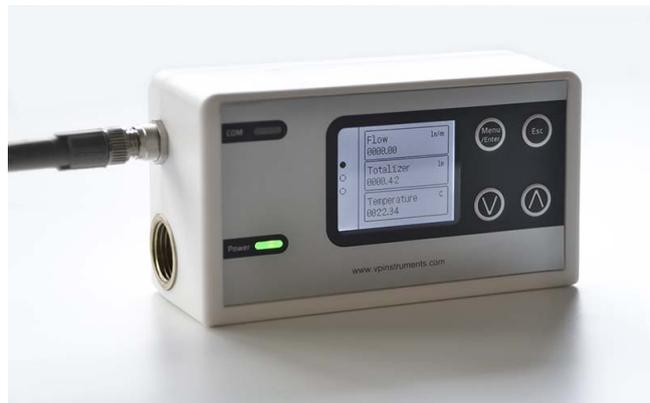
Con los pioneros diámetros más pequeños, el VPFlowScope In-line 3/8 pulgadas es la solución perfecta para medir flujos bajos de aire comprimido y oxígeno en el punto de uso. El VPFlowScope In-line de 3/8 pulgadas puede medir el flujo, el flujo total y la temperatura simultáneamente. Sus salidas Modbus y analógica le permiten conectarlo con VPVision u otros sistemas de control de energía.
